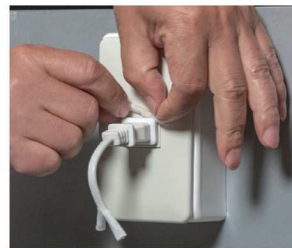
ホコリの代わりに手拭の切れ端をコンセントとプラグの間に挟みます。
