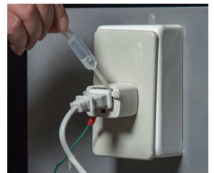
ホコリが湿気を含んだ状況を再現するために、手拭の切れ端にスポイトで水分を含ませます。
